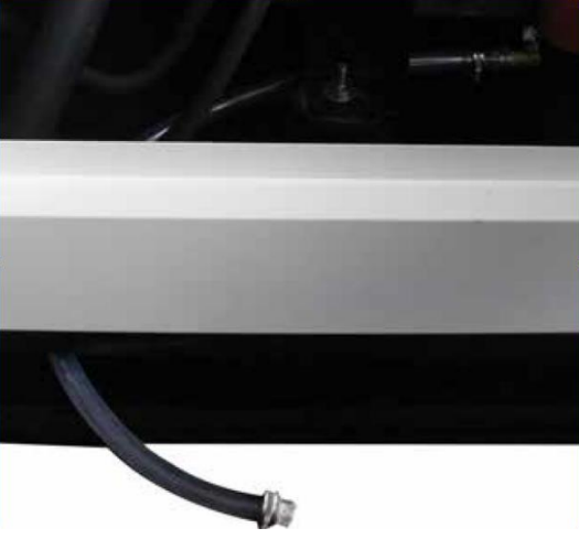
Şekil 6.1: Yağ Boşaltma Tapası
